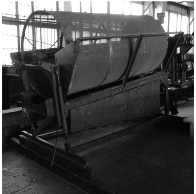
Рисунок 2 – Лабораторная установка для обоснования параметров и режимов работы барабана для отделения мелкой примеси
